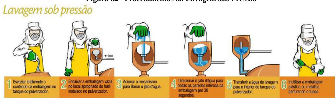
Figura 62 - Procedimentos da Lavagem sob Pressão
